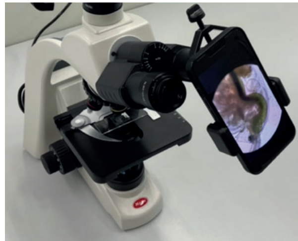
Abb. 2. Durchlichtmikroskop mit Okular-Aufsatz für Smartphone
